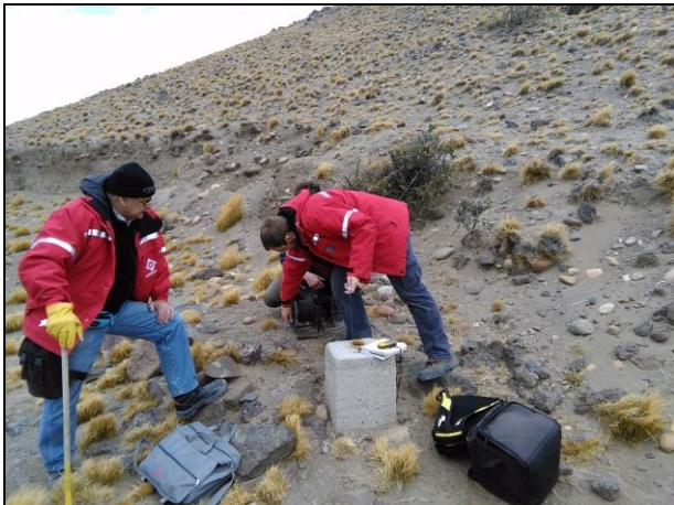
Figura 19. Relevamiento y medición de nivel de agua en pozos geotécnicos existentes en margen izquierda de JC
